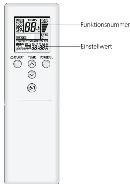
3. Die „SET TEMP.“-Tasten  $\wedge \vee$  drücken, um die Funktionsnummer zu wählen. Mit der „10 °C Heat“-Taste die linke oder rechte Ziffer auswählen.
