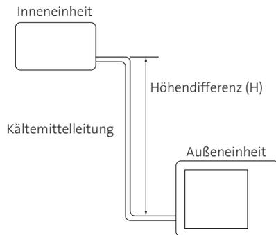
\*2) Inneneinheit tiefer montiert als Außeneinheit
