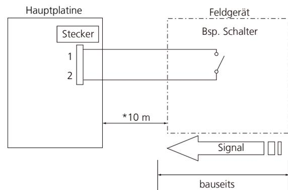
\* Die maximale Entfernung zwischen Steuerplatine und Schalter darf 10 m nicht überschreiten.
