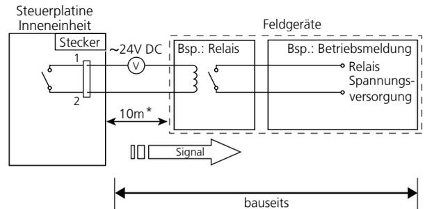
\* Die maximale Entfernung zwischen Steuerplatte und Schalter darf 10 m nicht überschreiten.
