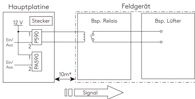
\* Die maximale Entfernung zwischen Steuerplatine und Schalter darf 10 m nicht überschreiten.
