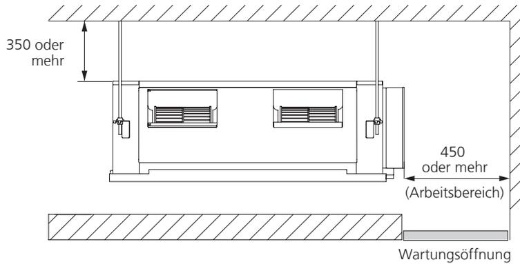
Installationen mit Zugriffsmöglichkeit über die Unterseite der Einheit.
