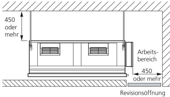
Bei Service von der Unterseite wird eine Revisionsöffnung über die komplette Breite benötigt.
